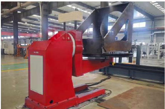
Позиционер L-типа для тяжелых нагрузок
