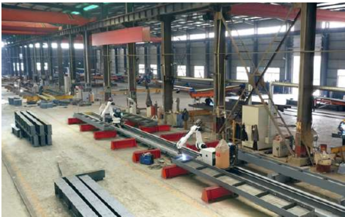
Схема зоны сварки рельсов длиной 12 метров
